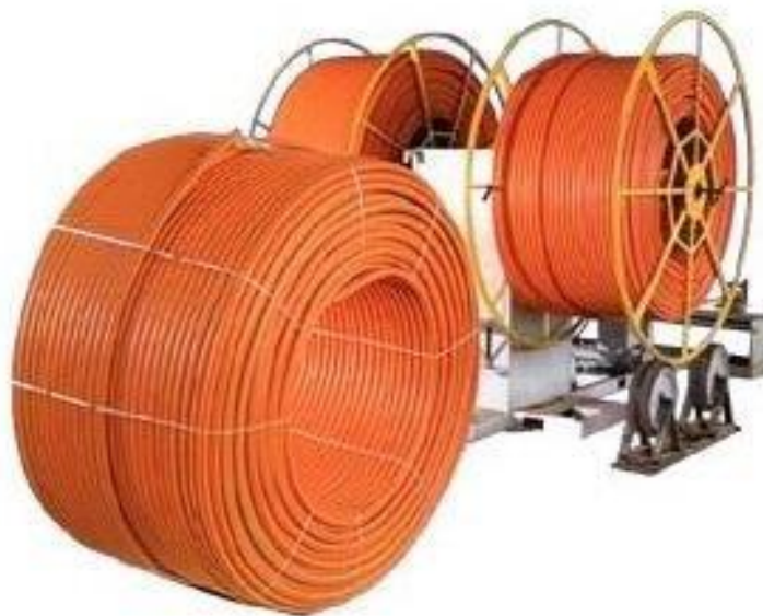
Рисунок 3.5 - Внешний вид защитных пластиковых труб Размеры барабана и бухт. Барабан: - диаметр 225 см; - ширина 105 см; - диаметр шейки 85 см; - диаметр осевого отверстия 11,6 см Большая бухта: - внешний диаметр 222,0 см; - внутренний диаметр 106 см; - ширина 104 см. Малая бухта: - внешний диаметр 210,0 см; - внутренний диаметр 145,0 см; - ширина 50-70 см.
